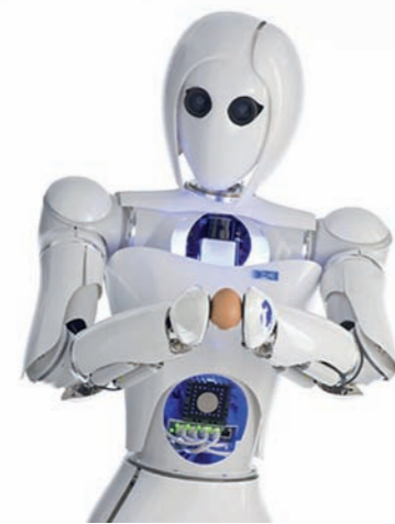
AILA – ein Dual-Arm-Service-Roboter für Handel und Logistik. ©DFKI
